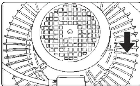
Andernfalls, um die Phasen der Stromversorgung zurückzusetzen, drehen Sie den Schalter (1) auf „O“, ziehen Sie den Stecker aus der Steckdose, stecken Sie einen Schraubendreher in den entsprechenden Schlitz im Inneren des Netzsteckers und vertauschen Sie die zwei Pole mit einer Drehung von 180°.
