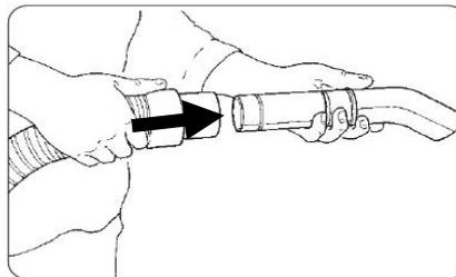
Anmerkung: Der Schlauch mit den entsprechenden Anschlüssen und das Zubehör für die Absaugung sind nicht in der STANDARD-Lieferung enthalten. Kontaktieren Sie Ihren Händler (oder DEPURECO), um Informationen über die verschiedenen OPTIONALEN Zubehörteile für Ihr Industriesaugermodell zu erhalten.
